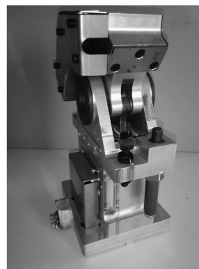
图8 传力机构的试验样机
