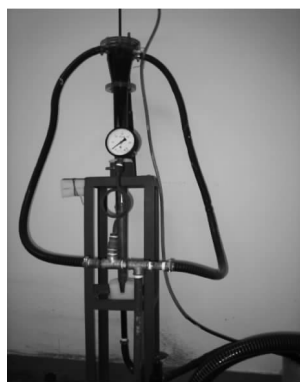
图 1 液液水力旋流分离器
