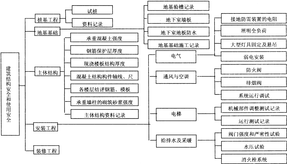
图 1 建筑安全性能指标体系 Fig 1 Construction safety performance indexes 设计质量不在质量监督机构监督的范围之内, 因此, 此指标未包括勘察设计质量。但从纵向来看, 该体系不仅包括了建筑安全性能的 3 大主控单元, 即桩基工程、地基基础以及主体结构, 还涉及到了工程系统的具体控制点, 把文献 [4] 中的承载力、施工试验、隐蔽工程等穿插到具体的工程系统中, 能更好的评价一个建筑的安全性能。
