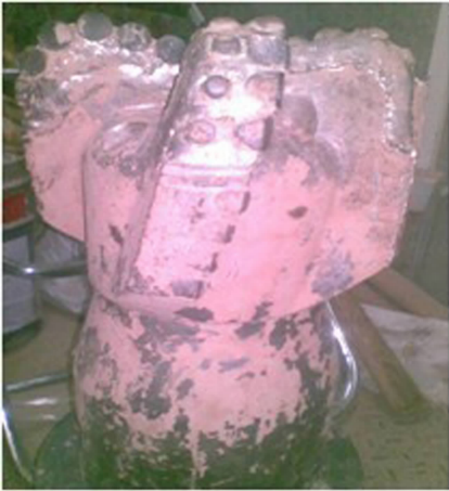
图 5 试验后钻头 Fig. 5 The tested PDC bit
