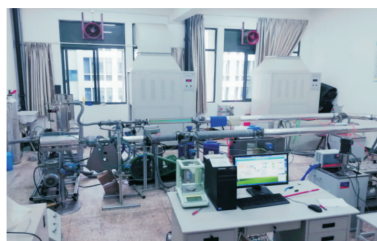
图 2 高压可视水合物环路
