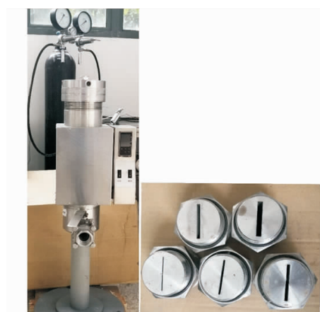
图 1 裂缝静态承压堵漏仪及裂缝块
