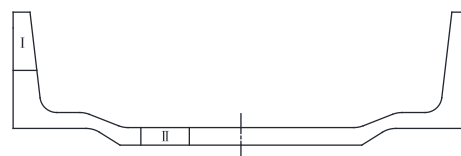
图 2 金相试样取样位置:直壁处 I ;底部 II
