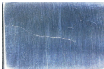
(b) 冷隔裂纹图
