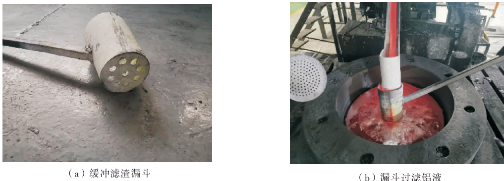
图 8 缓冲滤渣漏斗过滤铝液
