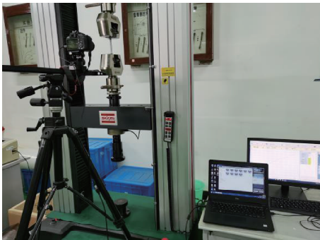
图 1 拉伸与 DIC 测试系统
